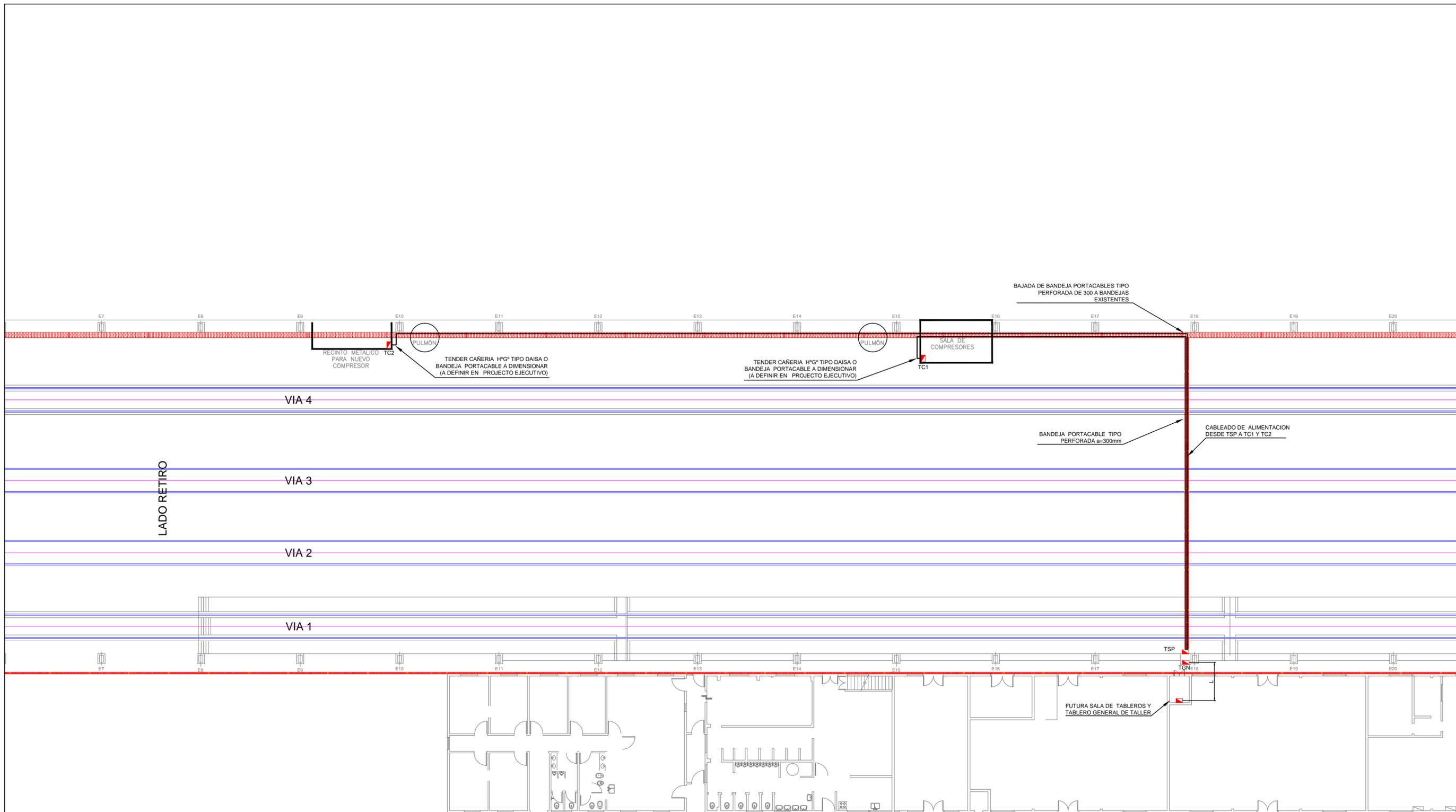
NOTA: LOS CABLES QUE ALIMENTAN LOS COMPRESORES DE AIRE Y QUE PARTEN DEL TSP, SE LES DEJARA UNA "RESERVA" A EFECTOS QUE DICHS CONDUCTORES, EN EL FUTURO, PUEDEAN SER CONECTADOS EN EL TABLERO GENERAL A INSTALAR EN LA "SALA DE TABLEROS". ESTA "RESERVA" (L) DEBERA SER APROBADA POR LA INSPECCION SOFSE
