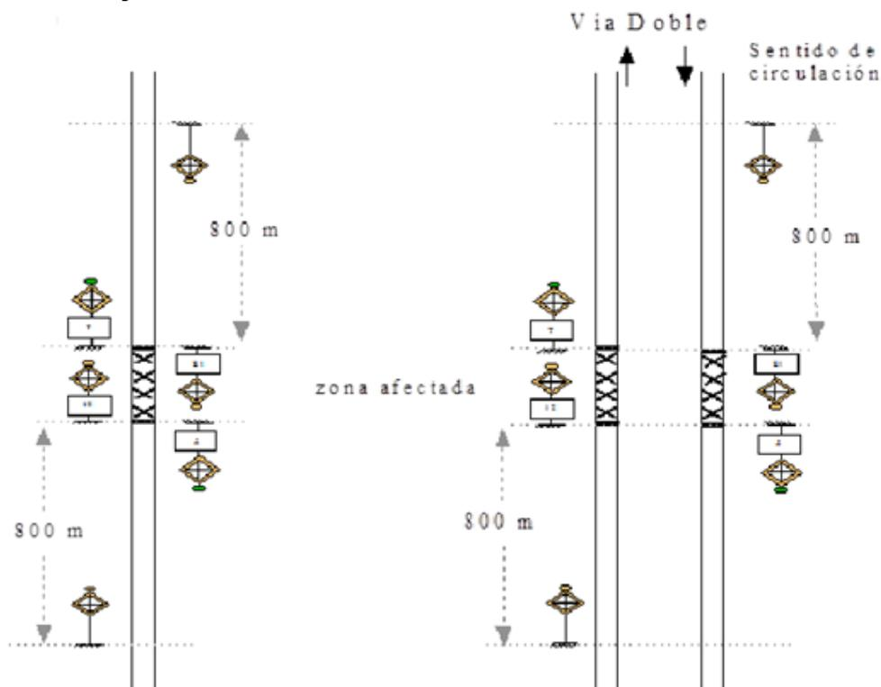
8.2.3. En los trabajos que se requiera la utilización de bandera y tablero de precaución al unísono se implementará según el grafico que al pie se detalla.
