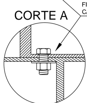
FIJAR CAJA A CHAPA 12 MEDIANTE TORNILLOS C/TUERCA Y ARANDELA (A DIMENSIONAR ) CANT : 4
