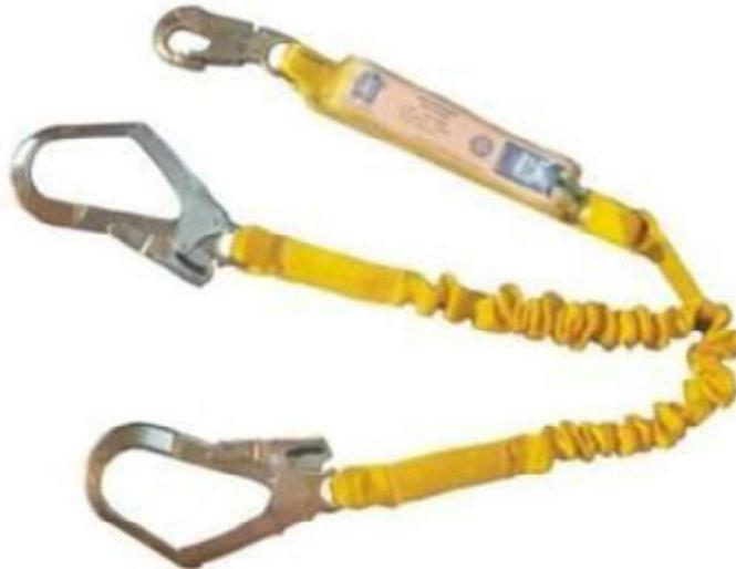
Las eslingas sin absorbedor de energía no deben ser utilizadas para detener caídas debido a las fuerzas de impacto que pueden producirse frente a una caída. La eslinga debe reducir al mínimo la fuerza sobre el trabajador a menos de 600 kg con una caída libre de hasta 1,8 m.
