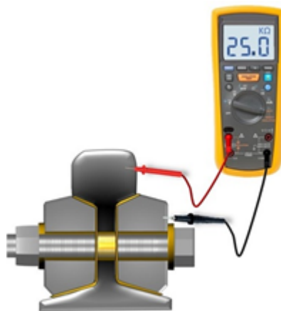
Figura 1: Medición de Resistencia Eléctrica
