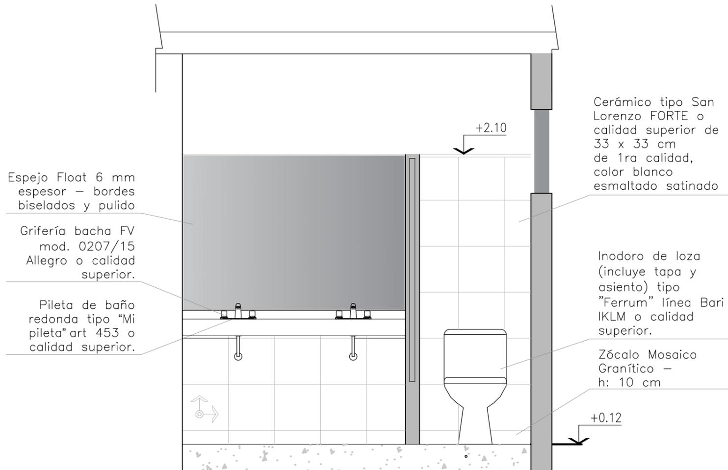
Espejo Float 6 mm espesor - bordes biselados y pulido
