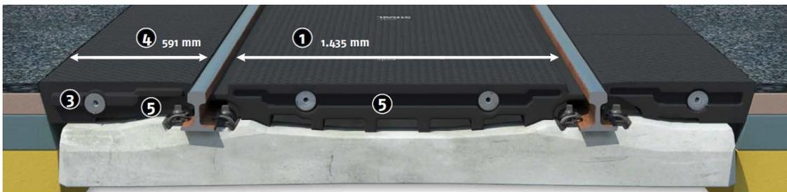
El producto ilustrado posee las siguientes características: longitud variable según trocha; sistema de anclaje longitudinal; conexión macho-hembra interplaca utilizando unión machihembrada, en la cual una pestaña de la loseta encastra en la ranura de la siguiente; la interface con el camino se realiza en forma directa con mortero asfáltico.
