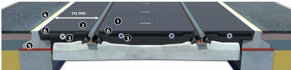
En este caso, la referencia N° 5 representa un cordón de hormigón longitudinal de interfase entre las placas de caucho y el camino, donde las mismas apoyan. Hacia el camino, se observa la referencia N° 4 perteneciente a una banda de elastómero que contacta el pavimento asfáltico con el cordón mencionado de hormigón.
