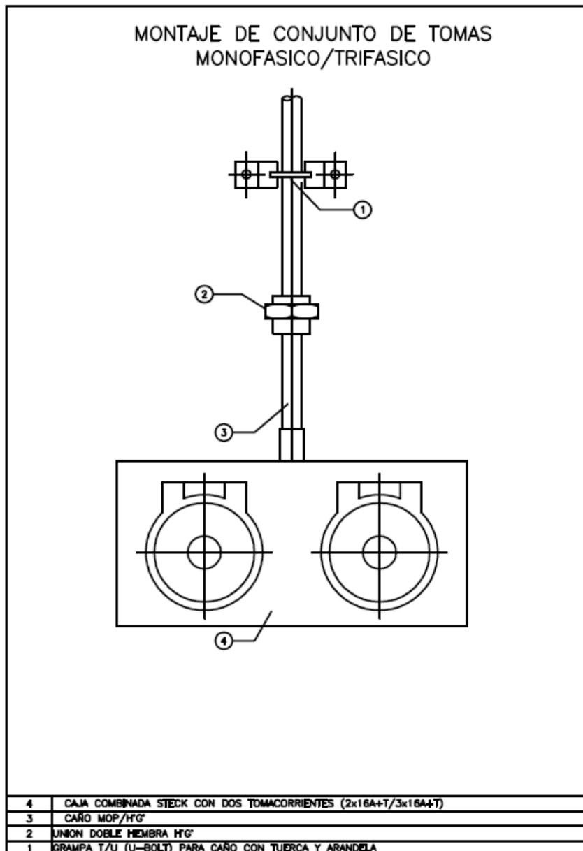
Imagen 12- Ilustración de referencia: Montaje de tomas
