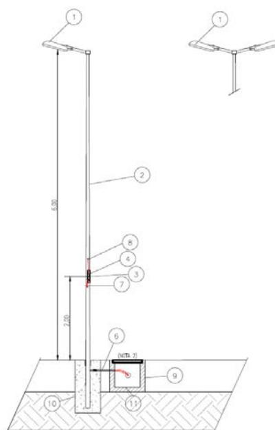
Imagen 8 – Detalle columna de Iluminación (Ver Anexo X)
