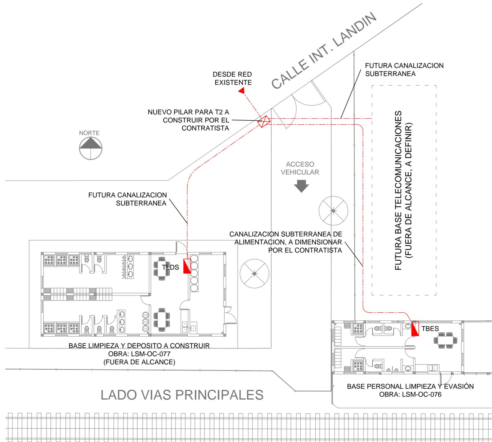
**ESQUEMA ORIENTATIVO CONDUCTOR ENTERRADO**
