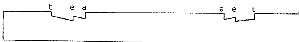
Durmiente con entalles terminados, inclinación 1:40
