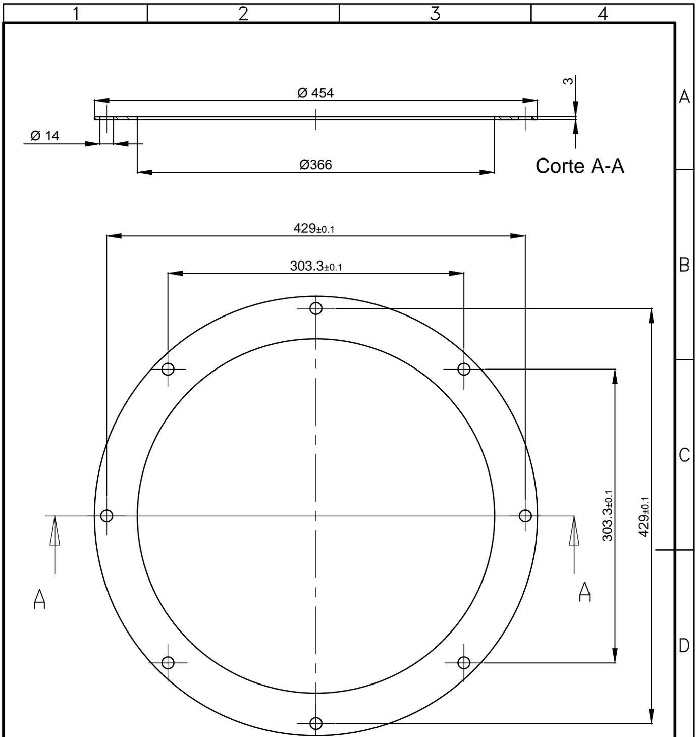
Material: Grafito flexible puro con insercion de làmina perforada de acero inoxidable AISI 316 de espesor 0.1mm
