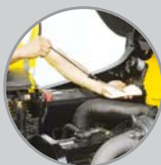
Comprobación del aceite del motor
