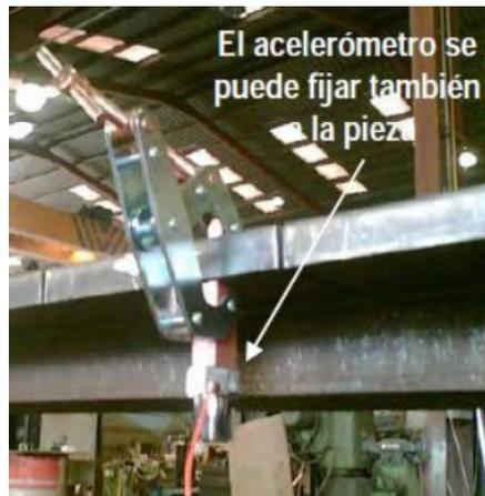
Ilustración 5: Fijación del acelerómetro a la pieza mediante abrazadera.
