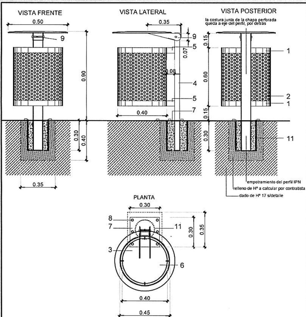
1. AROS DE PLANCHUELA DE HIERRO 2" ESP. 1/4" SUP. E INF. P/SOLDAR LA CHAPA PERFORADA
