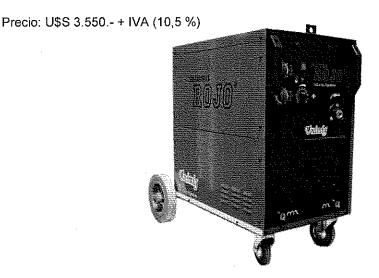
B) Una máquina de soldar Mag Mig de 350 amp. marca ROJO modelo MAXIMIG 350, con cabezal giratorio, provisto de 4 ruedas. Moto-reductor de 4 rodillos motrices (doble tracción). Apto para soldar alambres macizos y tubulares hasta Ø 1,2 mm. Posee en el cabezal 2 tiempos – 4 tiempos, punteo, ciclo Mag (pulsado de alambre), pos
