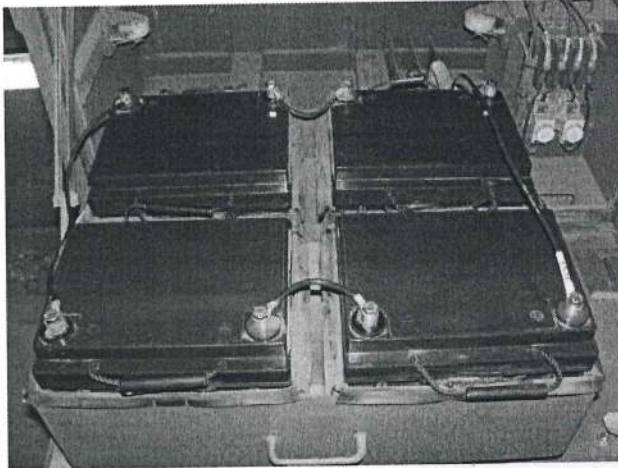
Fotos de instalación de las baterías dentro del compartimiento caja bajo piso.
