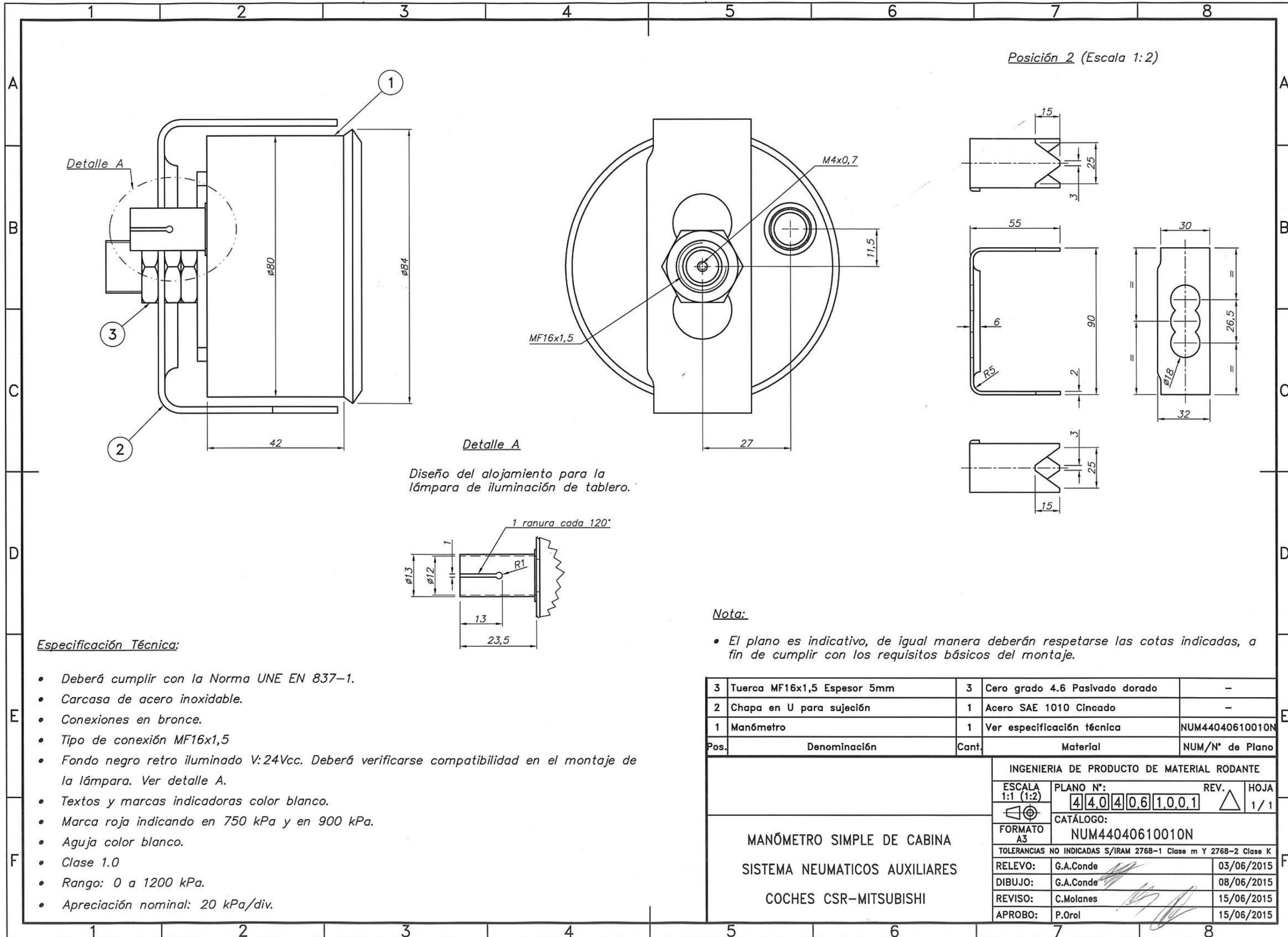
Diseño del alojamiento para la lámpara de iluminación de tablero.
