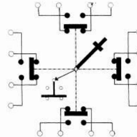
LA DIRECCION DE MANIOBRA DE LA PALANCA Y EL CONTACTO ATACADO SON DIAMETRALMENTE OPUESTOS
