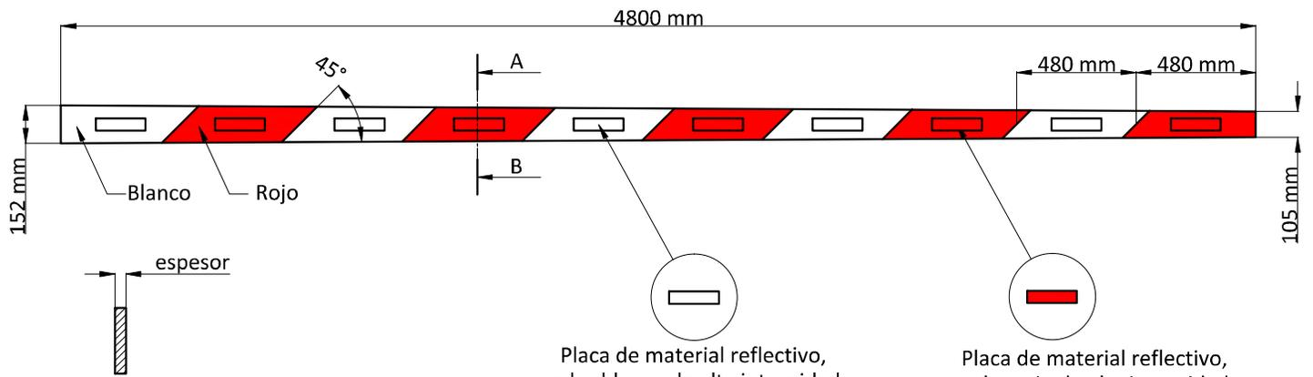
espesor = 25,4 mm; cepillado = 22 mm
