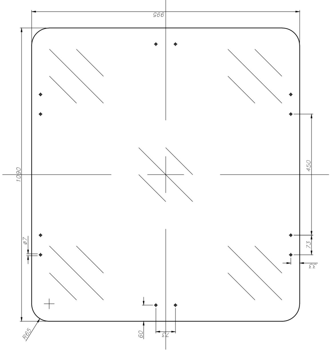
MATERIAL: Policarbonato monolitico antiabrasivo Esp:6 mm tipo Lexan MR10 con recubrimiento antiabrasivo Margard o de similares características
