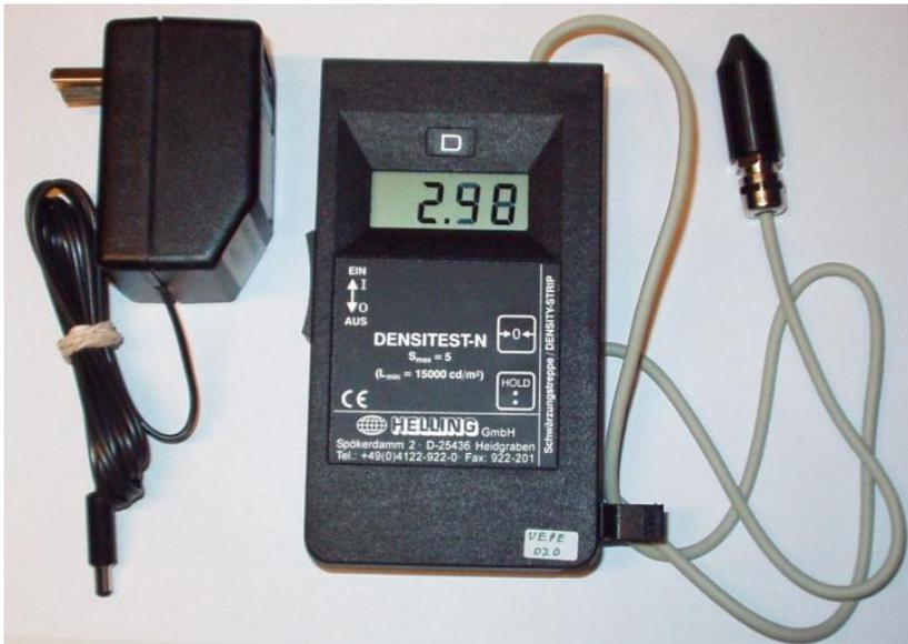
**DESCRIPCIÓN:** Densitómetro para medición de densidades de películas radiográficas sobre negatoscopio.
