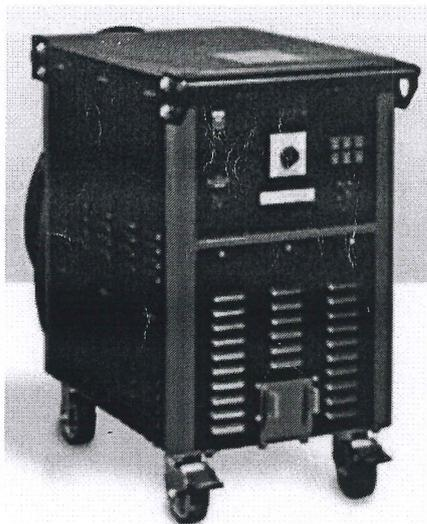
Salida: corriente de magnetización de 6.000 Amps AC y HWDC
