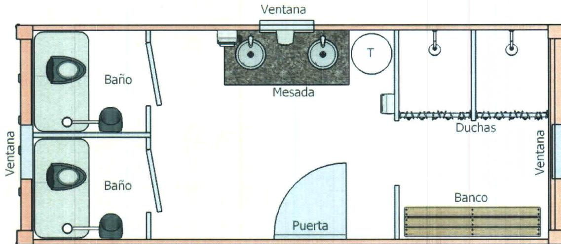
*Esquema tentativo (disposición de los elementos y aberturas a confirmar)*
