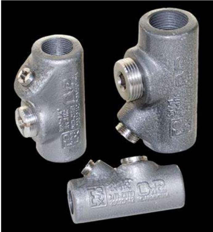
Los selladores universales, se utilizaran en los sistemas de cañerías para impedir el pasaje de gases, vapores o llamas, desde una parte de la instalación a otra a través de las tuberías, limitando cualquier explosión a su caja generadora. Su utilización es tanto para sellar cañerías en posición horizontal como vertical. Material de cuerpo en fundición de aluminio, pintura nitrosintetica gris.
