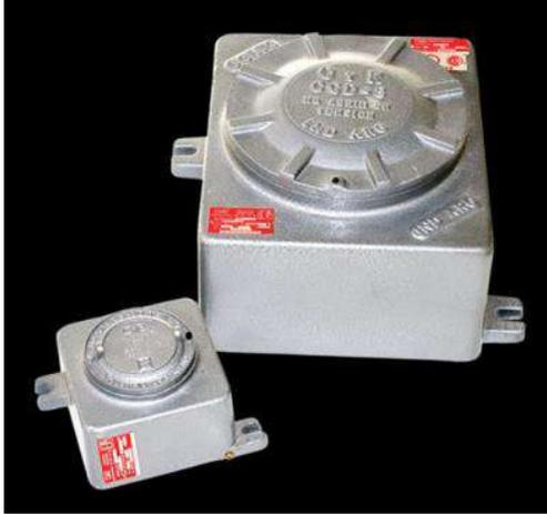
Las cajas cuadradas con tapa roscada, se utilizarán en los sistemas de cañerías rígidas. Su función será de caja de derivación y pase. Para alojar elementos como ser: fusibles, borneras, balastos para lámparas de descarga, y como caja de pie de columna.
