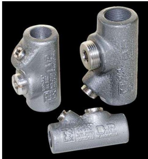
Los selladores universales, se utilizarán en los sistemas de cañerías para impedir el pasaje de gases, vapores o llamas, desde una parte de la instalación a otra a través de las tuberías, limitando cualquier explosión a su caja generadora. Su utilización es tanto para sellar cañerías en posición horizontal como vertical. Material de cuerpo en fundición de aluminio, pintura nitrosintética gris.
