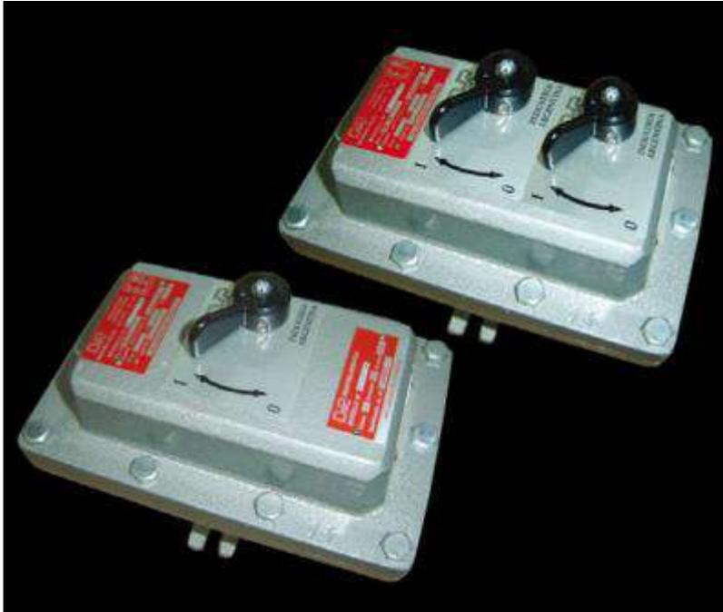
Las cajas con llaves Interruptoras son utilizadas comúnmente como elemento de corte de alimentación en artefactos de iluminación, motores monofásicos y trifásicos, etc. Se instalara dentro del recinto una caja con un interruptor común a palanca de un punto, que servirán para el accionamiento manual de las luminarias interiores. Material de fundición de aluminio con asiento de tapa y caja rectificadas y orejas de sujeción, pintura nitrosintética gris. Tipo de accionamiento: a palanca con topes.
