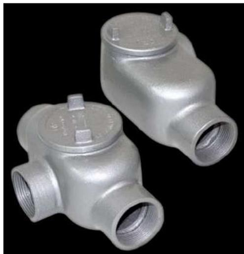
Los codos de paso con tapa roscada son utilizados en sistemas de cañerías de instalaciones eléctricas. Su función es proteger a los conductores eléctricos. Utilizar como caja de empalme o derivación, por lo tanto, permiten efectuar desvíos de cañerías. Poder unir extremos de conductores. Poder efectuar un fácil mantenimiento en el futuro o efectuar cambios en una instalación.
