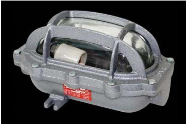
Para la iluminación interna del recinto con peligro de explosión, se utilizarán este tipo de artefacto, total de dos (2) artefactos tipo “tortuga” para lámpara bajo consumo o de led (de 100 W cada lámpara), los vidrios deben estar sellados a la reja. Material de cuerpo y reja en fundición de aluminio, vidrio de borosilicato, portalámparas rosca E27. Pintura nitrosintética color gris. Accesos: 2 a 180° de 3/4”.
