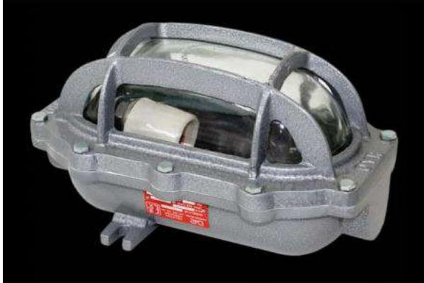
Para la iluminación interna del recinto con peligro de explosión, se utilizarán este tipo de artefacto, total de dos (2) artefactos tipo “tortuga” para lámpara bajo consumo o de led (de 100 W cada lámpara), los vidrios deben estar sellados a la reja. Material de cuerpo y reja en fundición de aluminio, vidrio de borosilicato, portalámparas rosca E27. Pintura nitrosintética color gris. Accesos: 2 a 180° de ¾”.
