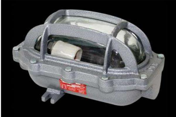
Para la iluminación interna del recinto con peligro de explosión, se utilizaran este tipo de artefacto tipo “tortuga”, los vidrios deben estar sellados a la reja. Material de cuerpo y reja en fundición de aluminio, vidrio de borosilicato, portalámparas rosca E27. Pintura nitrosintética color gris. Accesos: 2 a 180° de  $\frac{3}{4}$ ”.
