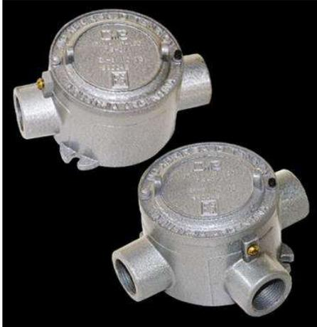
Las cajas de derivación redondas con tapa roscada se utilizan en general en el sistema de cañerías. Las mismas sirven para proteger a los conductores eléctricos. Utilizar como caja de empalme o derivación, por lo tanto, se pueden efectuar desvíos de cañerías. Poder unir extremos de conductores mediante el alojamiento en su interior de borneras para sección de cables de 2,5 hasta 10 mm. Poder efectuar un fácil mantenimiento en el futuro o efectuar cambios en una instalación.
