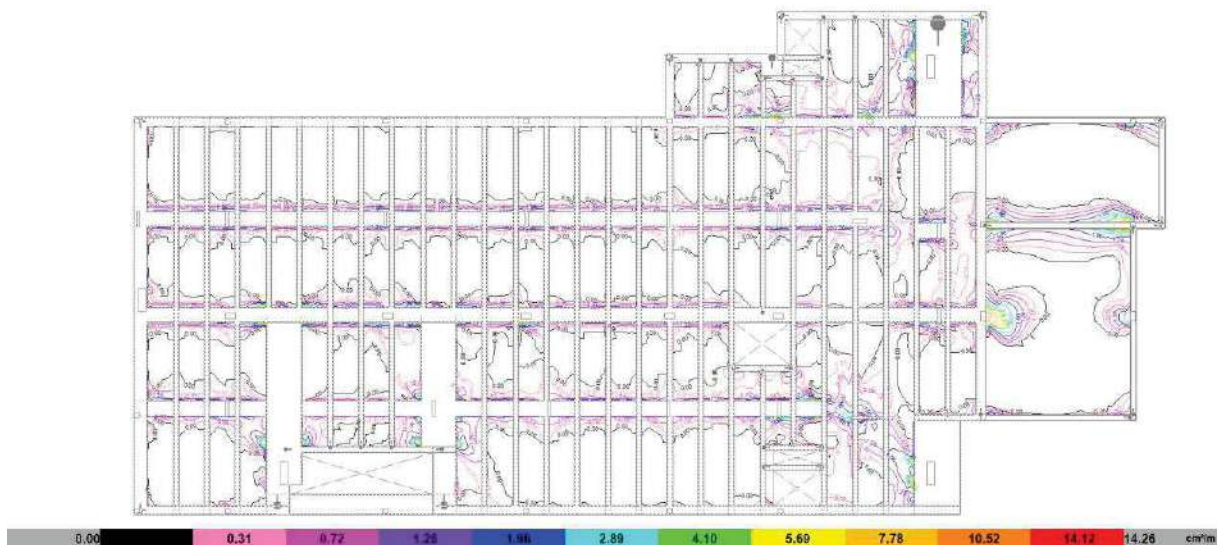
Figura 17 Cuantía de refuerzo necesaria en dirección Y
