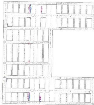
Figura 14 Cuantía de refuerzo necesaria en dirección Y
