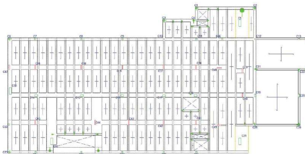
Figura 2 Esquema de la estructura del entrepiso del Sector B
