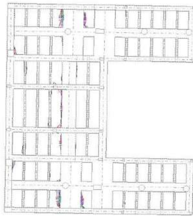
Figura 16 Cuantía de refuerzo necesaria en dirección Y
