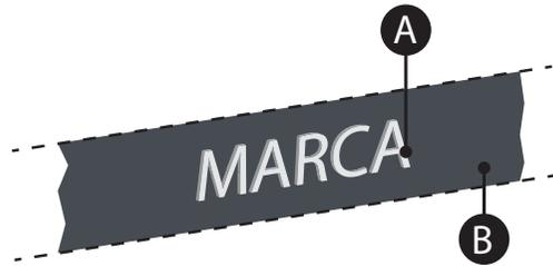
**A** Marca corpórea en espuma de poliestireno extruído (POLYFAN) pintado con pintura mate.
