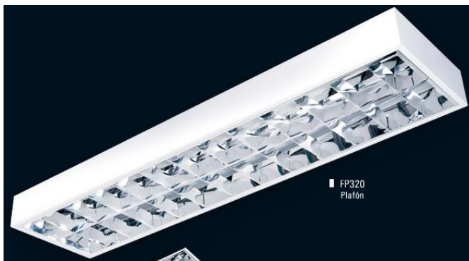
Plafón de luz fluorescente de 2x36 de estructura de chapa pintado al horno con esmalte color blanco y lúver doble parabólico metálico.
