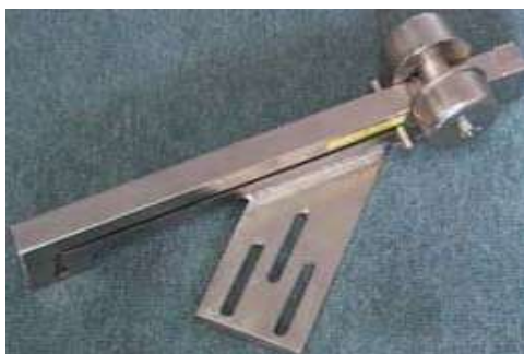
Figura 19 Foto de apariencia del dispositivo de lubricación en seco para pestaña de rueda
