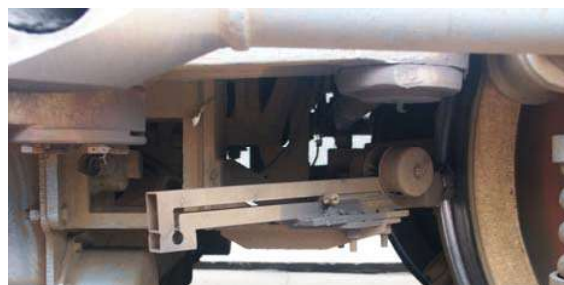
Figura 20 Foto del dispositivo de lubricación en seco para pestaña de rueda instalado en locomotora
