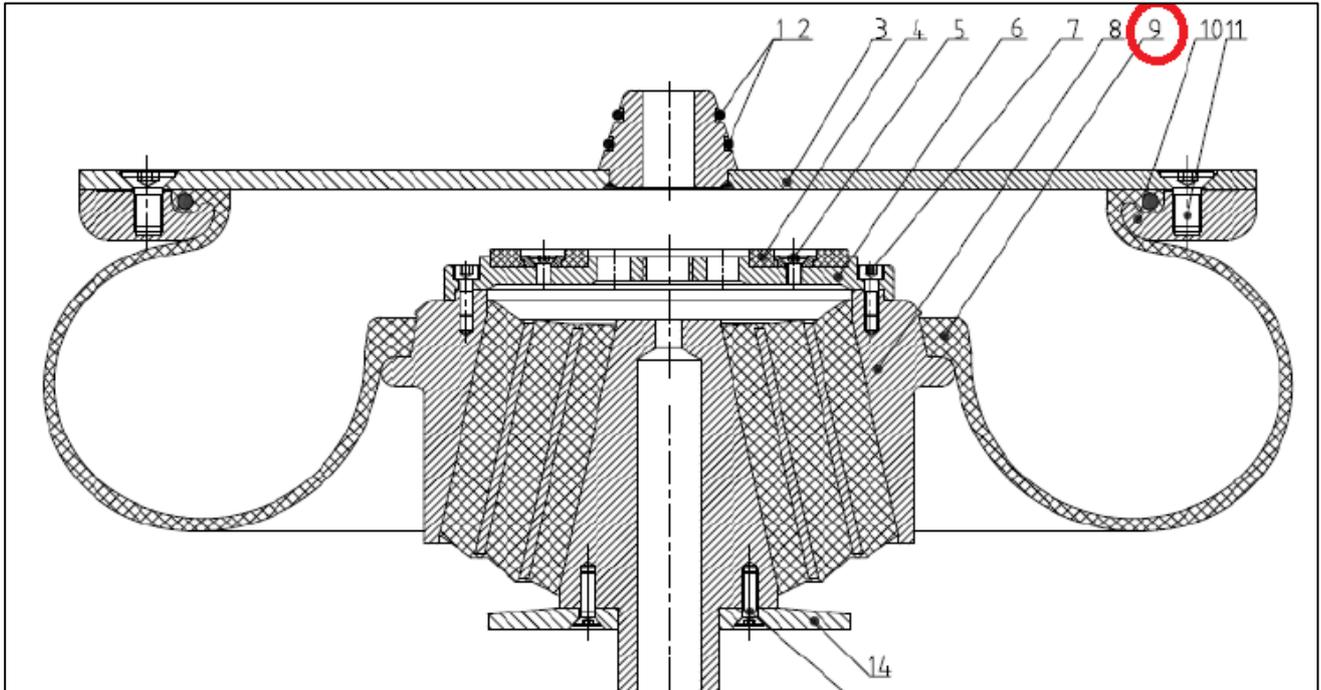
**Figura:** Conjunto de suspensión neumática secundaria. Ítem 9: Fuelle de caucho (repuesto solicitado).
