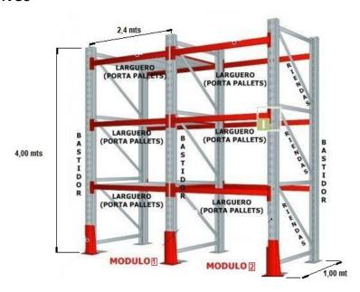
**Bastidor:** fabricados en chapa galvanizada. Matrizados en toda su longitud permite la regulación de las vigas cada 75mm.
