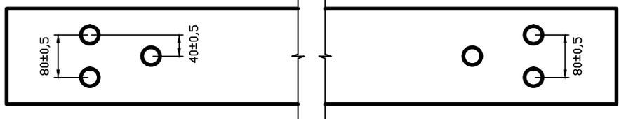
DISTRIBUCIÓN DE TIRAFONDOS EN CURVAS CON R<800m (COLOCACIÓN ALTERNADA) (TIPO B)
