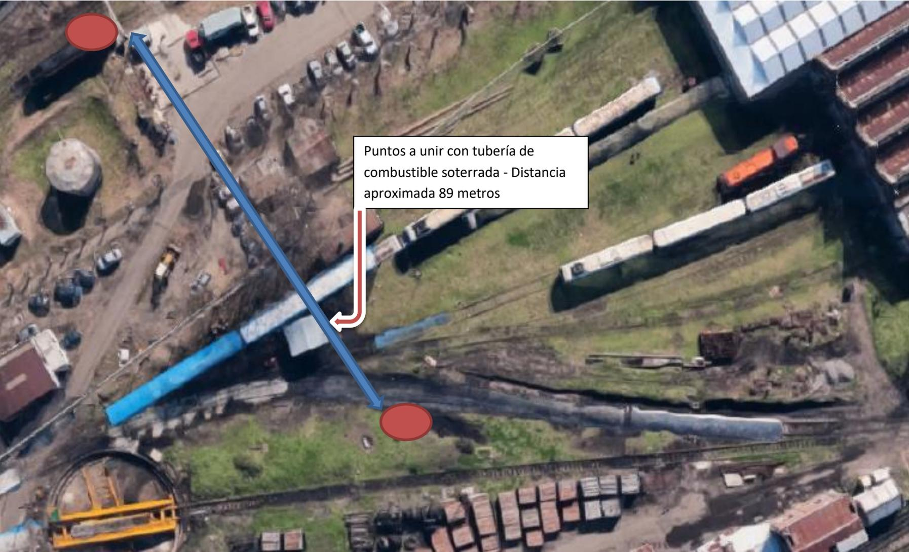
Puntos a unir con tubería de combustible soterrada - Distancia aproximada 89 metros
