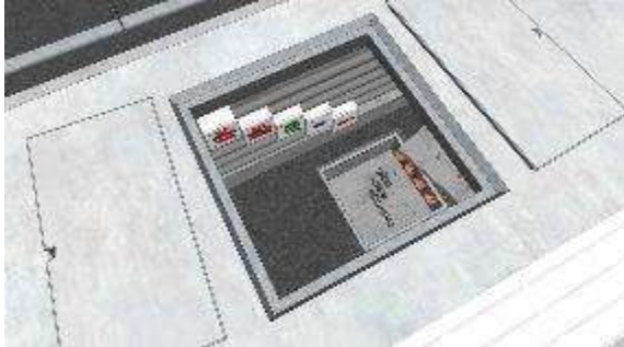
TAPAS DE ACCESO E INSPECCIÓN EN ANDENES
