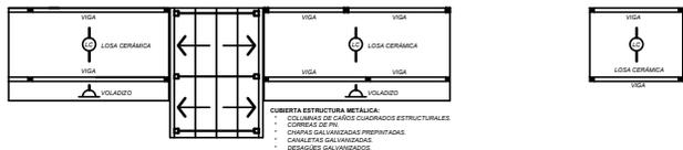
**PLANTA DE TECHOS DESAGÜES PLUVIALES**
