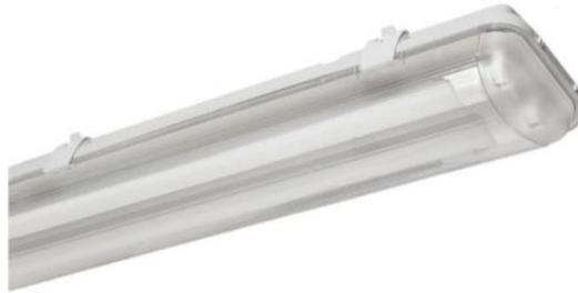
Artefacto Lumenac Marea o calidad superior Modelo 220/850: Cuerpo: en inyección de policarbonato auto extingible V2, con burlete de poliuretano. Con reflector: de chapa galvanizada y prepintada poliéster blanca. Difusor: en policarbonato inyectado, estabilizado para rayos UV. Vida útil: 35.000 hs.
