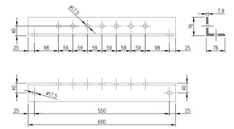
En este plano se muestran los perfiles del Brazo Colgante fijados en la parte superior por el marco superior (fijación interior) y en la zona media fijados por los ángulos inferiores (con abrazadera), no obstante, para sortear los distintos obstáculos ya instalados en los pórticos, hay otros modelos de marcos superiores y de ángulos inferiores según el siguiente detalle:
