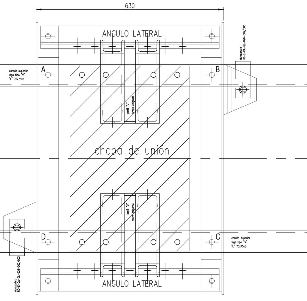
Se emplea cuando la chapa de unión está sobre un montante y no parten diagonales hacia el cordón inferior de la viga.
