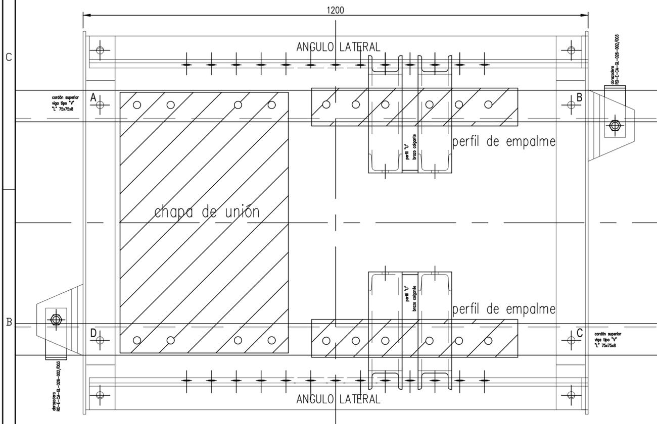
Se emplea cuando la chapa de unión está sobre un montante y parten diagonales hacia el cordón inferior de la viga, al mismo tiempo muy cerca de los perfiles de empalme, lo que obliga a separarse de las mismas para que puedan entrar las abrazaderas.
