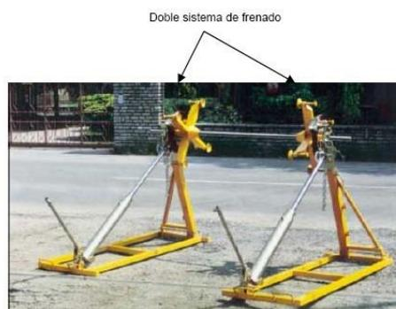
Figura 18.- Sistema frenado en alza bobinas
