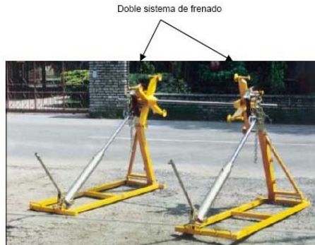
Figura 18.- Sistema frenado en alza bobinas
