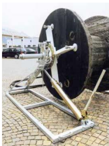
Figura 17.-Sujeción de los platos
