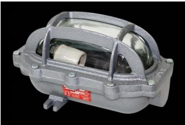
Para la iluminación interna del recinto con peligro de explosión, se utilizaran este tipo de artefacto, total de dos (2) artefactos tipo “tortuga” para lámpara bajo consumo o de led (de 100 W cada lámpara), los vidrios deben estar sellados a la reja. Material de cuerpo y reja en fundición de aluminio, vidrio de borosilicato, portalámparas rosca E27. Pintura nitrosintética color gris. Accesos: 2 a 180° de ¾”.
