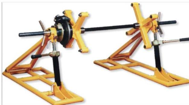
*Sistema de frenado en alza bobinas*
