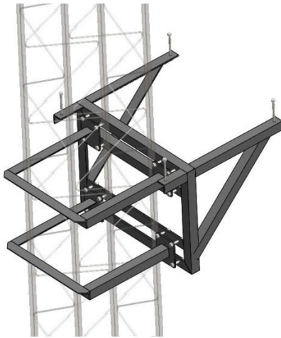
Soporte a columna existente.
