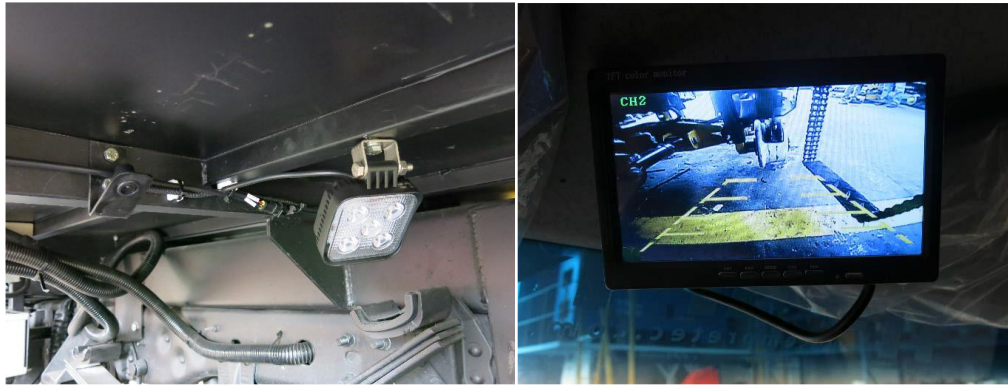
Detalle de la cámara para ver los juegos de ruedas
