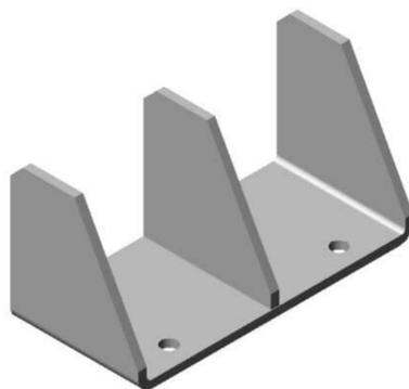
*Nota: La posición de las perforaciones  $\varnothing 18$  se determinará prácticamente en obra. Eliminar cantos vivos y/o rebabas.*
