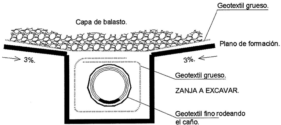
Este drenaje se conectará con un conducto transversal que desagua en la zanja lateral.
