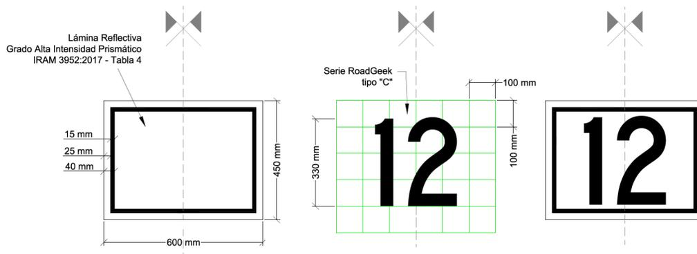
Cabe destacar que la velocidad máxima establecida para un tramo precaucionado variará según necesidad operativa, esta indicación (12 km/h) es solamente un ejemplo visual sobre las proporciones del cartel y de los números.
