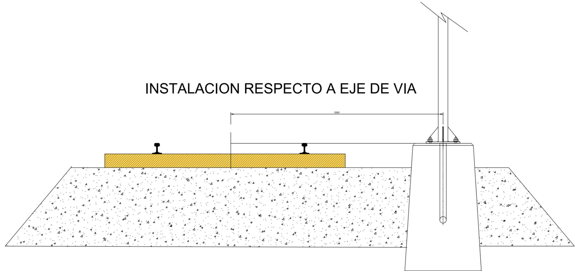
BASE DE HORMIGON PARA SEÑALES DE PASO A NIVEL
