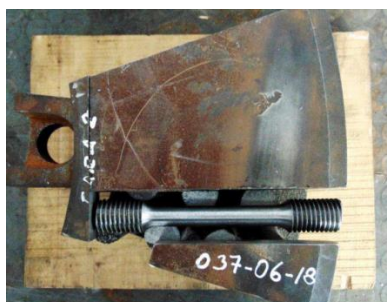
1. Probeta mecanizada para caracterización.
