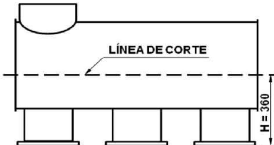
Limpiar meticulosamente el escape por medio de arenado o granallado en toda su superficie (interior y exterior) a los efectos de no dejar rastros de suciedad ni superficies corroídas u otro defecto.
