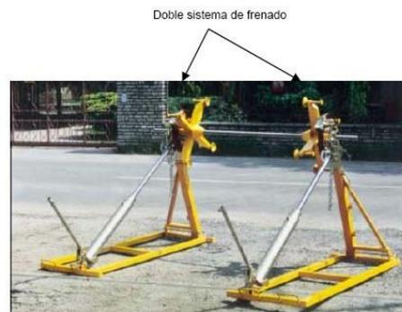
Figura 18.- Sistema frenado en alza bobinas
