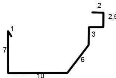
Todas las nuevas bajadas pluviales en los laterales del taller; irán por el lado exterior de la mamposterías; y sirven para la recolección y conducción de aguas de lluvia vinculadas hacia los canales longitudinales con tapa que corren por debajo de la vereda perimetral.
