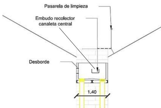
Se proveerá una rejilla guarda hojas de sección semiesférica y base igual o mayor a la del empalme; de hierro ángulo y planchuela como estructura / bastidor, la reja será de alambre calibre BWG N° 13 galvanizada con separaciones entre sí de 10.26mm.
